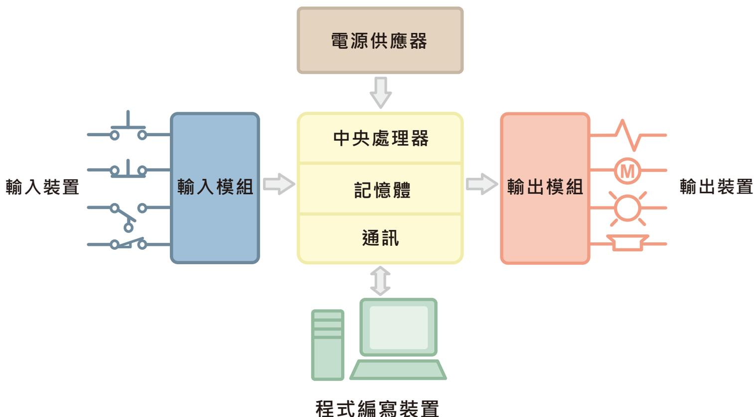
PLC用於使電機機械自動化，PLC從輸入設備接收信息，處理數據，並根據預先寫入的程式參數觸發輸出，它是一種靈活而強大的控制解決方案，幾乎適用於任何應用。
