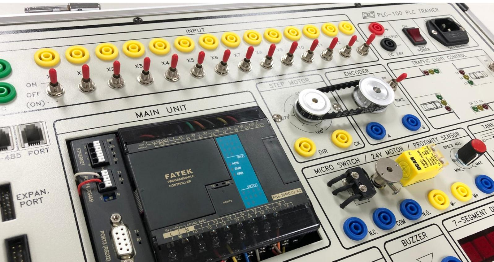
自從1970年首次推出PLC(Programmable Logic Controller, 可程式邏輯控制器), PLC已被廣泛應用於各種工業用途, 例如機械控制及程序控制。採用最新的微處理器以及電子電路技術, PLC的體積大幅縮小, 卻具有高水準的可靠性、性能、速度和網路功能。在自動化生產線使用PLC, 可提高系統可靠性、產品質量、資訊共享、製造效率以及生產的靈活性, 從而降低了成本。
