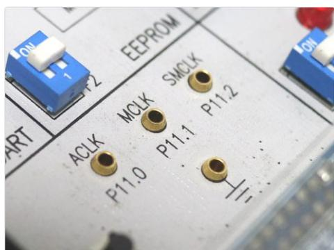
SMCLK(次要的系統主時鐘)、MCLK(系統主時鐘)、ACLK(輔助時鐘)。
