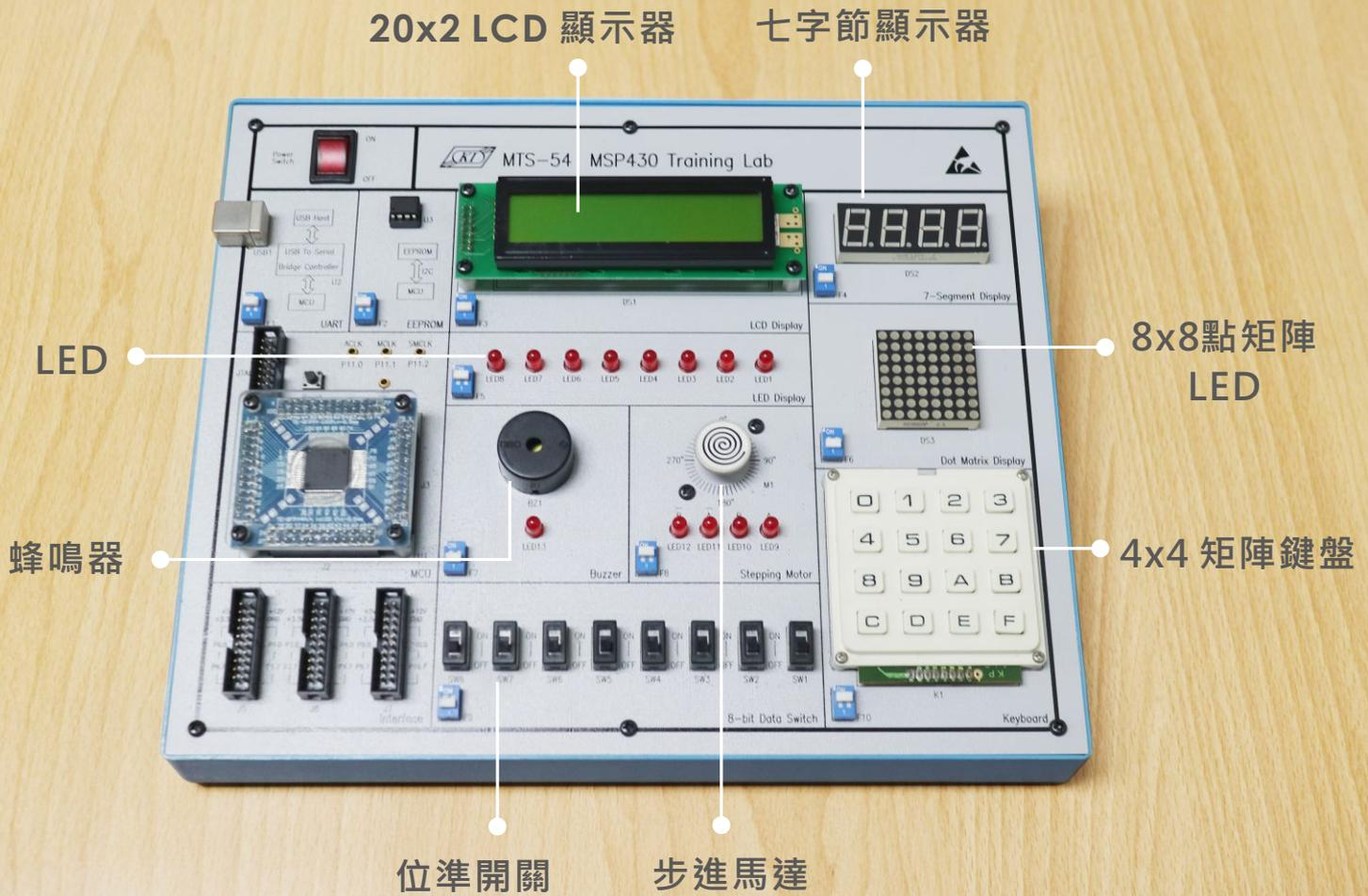
這個實驗器整合豐富的I/O元件，並包括多個從基礎的I/O控制到進階的應用範例。使用者將能更有效率的學習如何控制MSP430 MCU。
