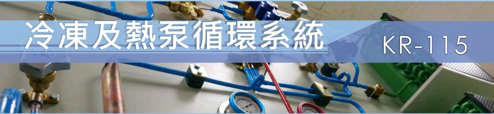
KR-115是專門為學習冷凍工程中的熱傳導理論所設計的。冷凍及熱泵循環系統除了四大主要元件之外，還需要包括儲液器、分液器及乾燥過濾器等輔助元件，KR-115將所有系統所需的元件安裝在面板上，方便學生直接操作和觀察。
