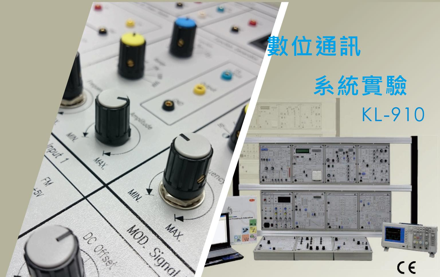
KL-910 是一種模組化的實驗訓練器，有各種不同的通訊系統實驗，採用開放式模組的實驗方式，具有擴增實驗範圍的能力，包括數位編碼/解碼器，調變/解調變等相關技術，發展及實踐現代化通訊系統的理論。
