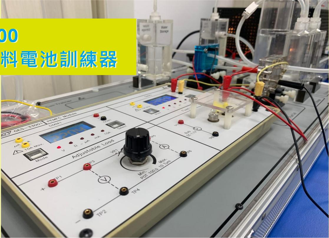
GES-300 是質子交換膜燃料電池的基礎訓練器，它讓學生了解如何通過電解生產燃料，並使用生產的燃料發電。
