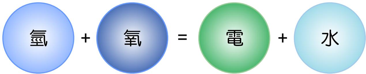
氫氧燃料電池技術幾乎可以為任何需要電力的設備提供乾淨、有效且可靠的電力來源。它是一種設計用於將化學能轉換為電能的裝置，燃料電池所產生的生成物只有水和熱能。
