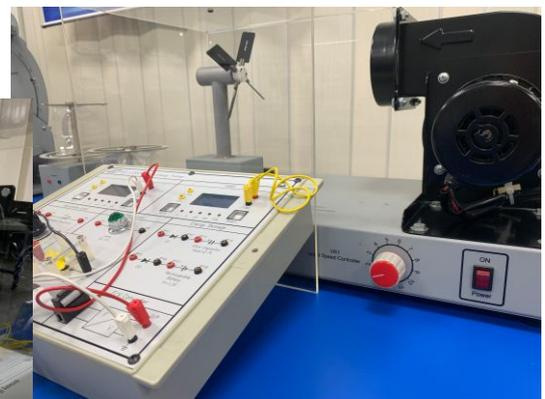
三種不同類型的葉片允許用戶調整數量和傾斜角度，藉以了解葉片角度和數量對輸出功率的影響。
